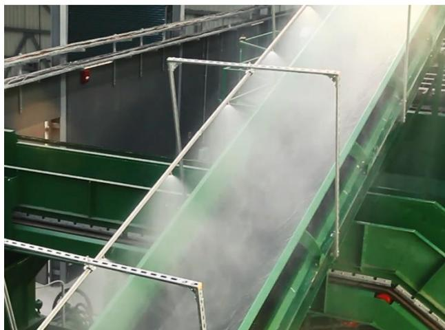
Das N-Pipe Typ I-C-1,5 mit einer Länge von 6 m ist mit 6 Niederdruck-Feinsprühdüsen (Modell BM1-28) und das N-Pipe Typ 3V-C2,5 mit einer Länge von 6 m ist mit 18 Düsen (BM1-20 und BM1-28) ausgestattet.
