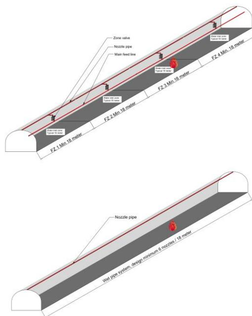
Der Wasserverbrauch bei Verwendung der Düse CT-ODC1 (offene, hängende Düse) muss auf der Grundlage von mindestens 2 Zonen von 18 Metern oder mehr ausgelegt sein. Es wird jedoch empfohlen, 3 Zonen zu verwenden.
